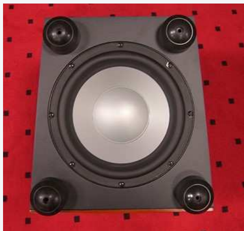
Die aktive Membran des Subwoofers strahlt nach unten ab
